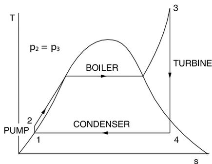
$$\eta = \frac{(h_3 - h_4) - (h_2 - h_1)}{h_3 - h_2}$$
