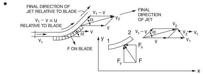
$$-F_x = Q\rho(v_{2x} - v_{1x}) = -Q\rho(v_1 - v)(1 - \cos \alpha)$$
