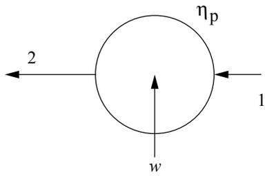
$$w = h_1 - h_2 = (h_1 - h_{2S}) / \eta_P$$
