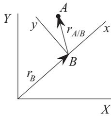
$$\begin{aligned} \mathbf{r}_A &= \mathbf{r}_B + \mathbf{r}_{A/B} \\ \mathbf{v}_A &= \mathbf{v}_B + \boldsymbol{\omega} \times \mathbf{r}_{A/B} + \mathbf{v}_{A/B} \\ \mathbf{a}_A &= \mathbf{a}_B + \boldsymbol{\alpha} \times \mathbf{r}_{A/B} + \boldsymbol{\omega} \times (\boldsymbol{\omega} \times \mathbf{r}_{A/B}) + 2\boldsymbol{\omega} \times \mathbf{v}_{A/B} + \mathbf{a}_{A/B} \end{aligned}$$
